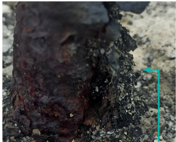
A perda de massa por conta da corrosão afeta o desempenho dos elementos de aço, tornando o material menos resistente à medida que a taxa de corrosão aumenta
